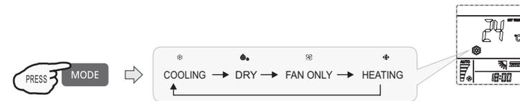
Переключение между режимами кондиционера занимает определенное время. При включении кондиционера на режим нагрева, кондиционер тратит от 2 до 5 минут на разогрев теплообменника, после чего подует теплый воздух.
