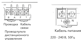
Увеличенный вид проводкиклеммной коробки(ТВ), деталь P
