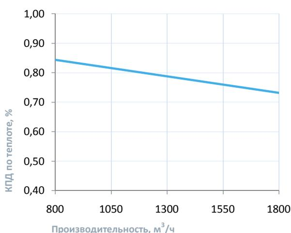
\* На вентхарактеристике указана производительность приточного канала. Производительность вытяжного канала может регулироваться от 70% до 120% приточного канала. КПД рекуператора показано для соотношения расходов воздуха 1:1.
